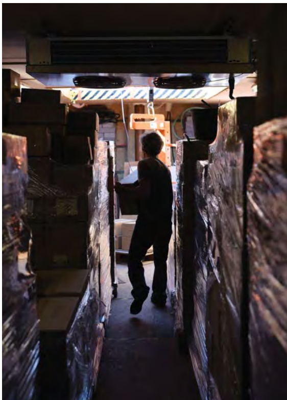
La cale est isolée, étanchée, climatisée afin de garantir une maîtrise de la température et de l'hygrométrie tout au long du voyage. Une vraie cave ambulante !
